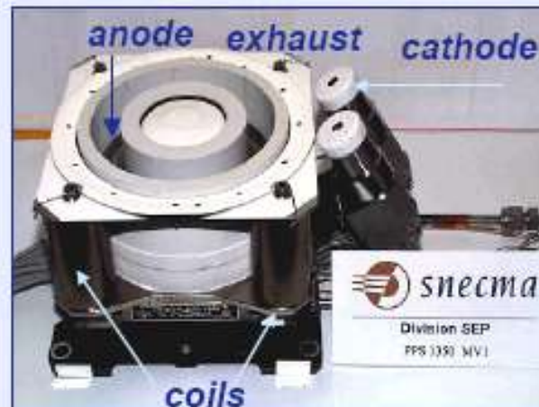
Mission lunaire ESA SMART 1 Moteur plasma SNECMA PPS1350
