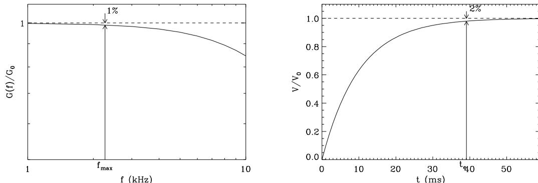
Cet exercice illustre le fait que, pour effectuer une mesure correcte à l'aide d'un dispositif linéaire, il est nécessaire de se situer bien en dessous de la fréquence de coupure et de laisser le système s'établir sur des temps d'établissement bien plus grands que le temps caractéristique du système.
